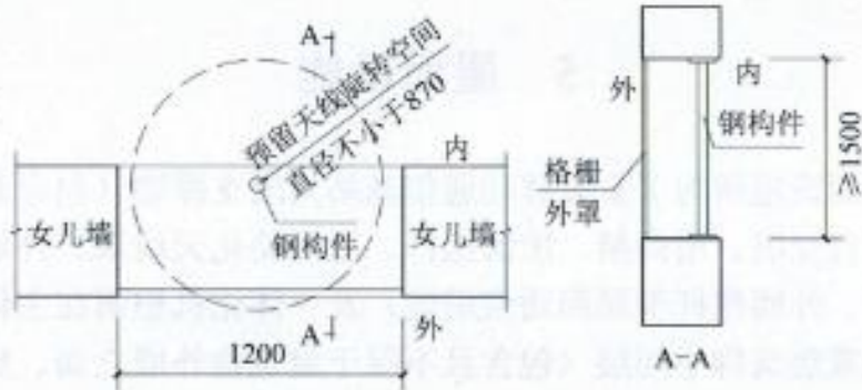
(a) 洞口内设置钢构件
