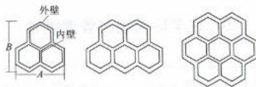
图6 蜂窝式塑料管横断面形式
